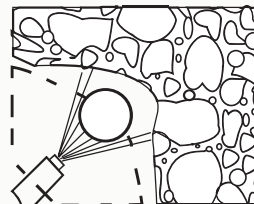
Sabler ou brosser l'acier et le béton pour enlever la rouille et les parties non adhérentes.
