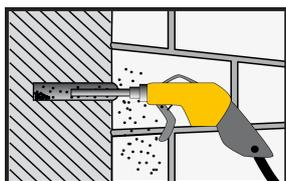
2. Le trou de perçage doit être nettoyé avec de l'air comprimé sans huile, pression : 6 Bar (90 psi). Commencez par le fond du trou et nettoyez au moins 2 fois jusqu'à ce que le jet d'air soit exempt de poussière
