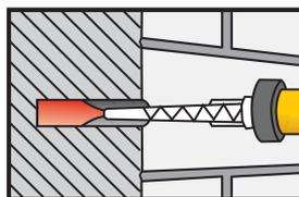
8. L'injection se fait en partant du fond tout en reculant progressivement la buse de mélange tout en extrudant la résine dans le trou. Éviter les inclusions d'air dans la résine. Pour les trous profonds, utilisez des tubes d'extension.
