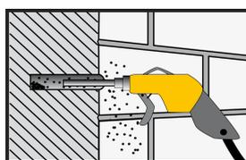
6. Le trou de perçage doit être nettoyé à nouveau comme aux étapes 2 et 4.
