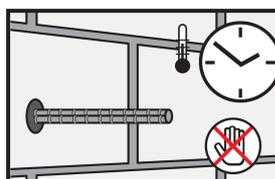
10. Pendant le temps de durcissement de la résine, l'ancrage ne doit ni être déplacé ni mis en charge.
