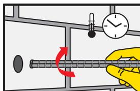
9. Insérez l'élément à sceller avec un mouvement rotatif dans le trou rempli de la résine pendant son temps ouvert. Une partie de la résine doit ressortir du trou de forage.
