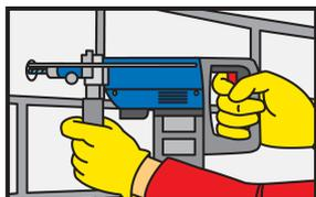
1. Percez un trou avec une perceuse électrique aux dimensions et à la profondeur requises. Le diamètre du trou doit être conforme à la taille de l'ancrage.
