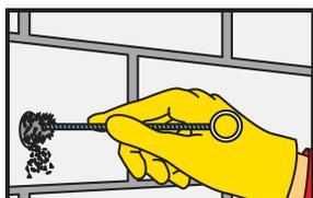
3. Le trou de perçage doit être soigneusement nettoyé à l'aide d'une brosse en acier spéciale (brosser au moins 2 fois). Le diamètre de la brosse doit être supérieur au diamètre du trou de perçage.
