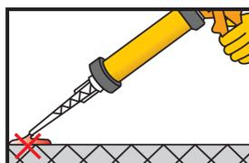
7. Par pressions sur la gâchette du pistolet, extruder le mélange en dehors du trou jusqu'à obtenir l'homogénéisation des 2 composants en sortie de buse (un mélange non homogène ne doit pas être utilisé pour effectuer un scellement). Relâcher la pression du pistolet, puis nettoyer le bout de la buse avant d'injecter la résine dans le trou de forage.
