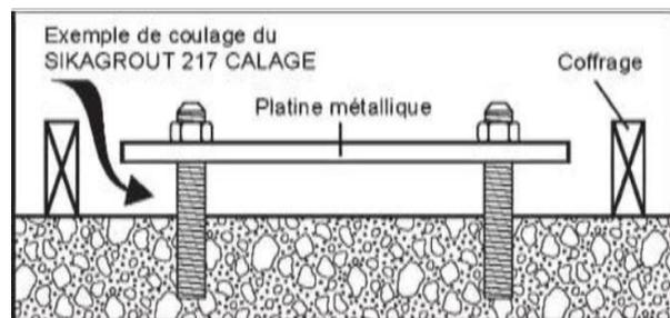
Pour réaliser des calages de grandes dimensions, il est possible de composer un micro-béton de calage conservant une fluidité et des résistances mécaniques à 28 jours non modifiées, comparativement à SikaGrout®-217 Calage M non chargé.
